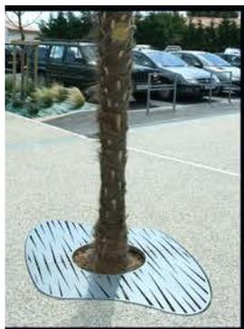
**Structure :** Cadre : Cornière acier 45 x 40 x 4 et rond  $\varnothing$  6 mm pour scellement. Grille : Réalisation tout acier en tôle épaisseur 8 mm et renforts en plat 26 x 6 mm.
