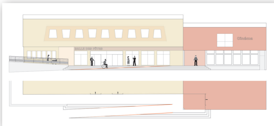
Vues en plan et en élévation de l'accès mutualisé pour la salle des fêtes et le cinéma avec l'aménagement d'un escalier avec rampe PMR intégrée
