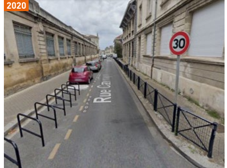
Δ La phase d'observation débute par un aménagement minimal avec l'installation d'arceaux vélos et le passage à 30 km/h.
